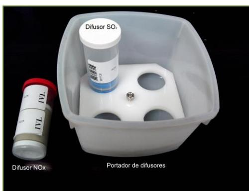
Figura 10. Difusores pasivos de  $NO_x$  y  $SO_2$ , junto al portador/protector para ambientes exteriores.
