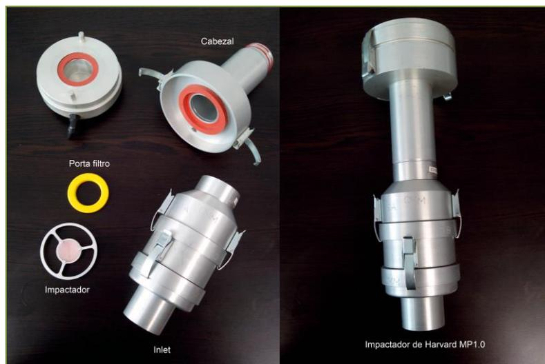
Figura 7. Impactador de Harvard separado en sus diferentes partes (izquierda) y ensamblado (derecha).
