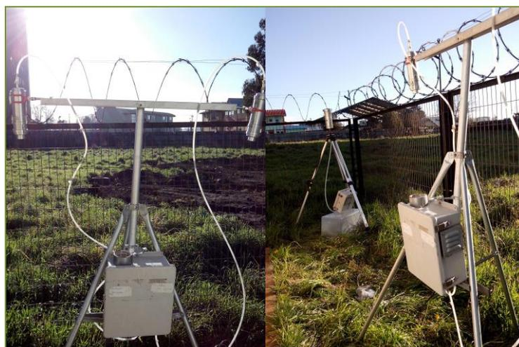
Figura 9. Impactadores de Harvard extra-domiciliarios. Izquierda: impactadores conteniendo filtros de teflón y cuarzo, para análisis de gravimetría/elementos y CE/CO. Derecha: ambos sistemas de impactadores, al fondo impactador con filtro para análisis de levoglucosano.
