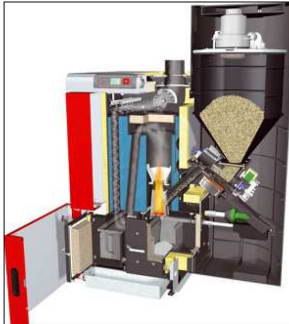
FIGURA 3.15-2. CALDERA CONVENCIONAL A PELLETT
