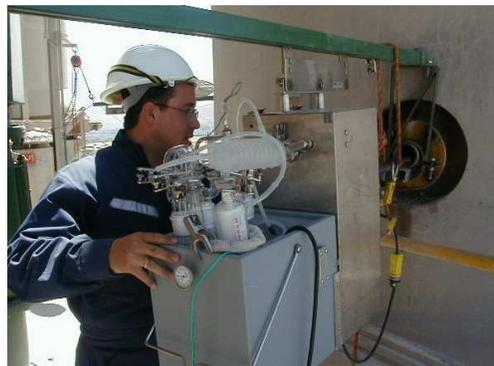
El filtro y la resina son enviados a un laboratorio en USA para la extracción y posterior análisis, de acuerdo a los métodos 8280 o 8290 usando cromatografía gaseosa de alta resolución y espectrometría de masa de alta resolución.
