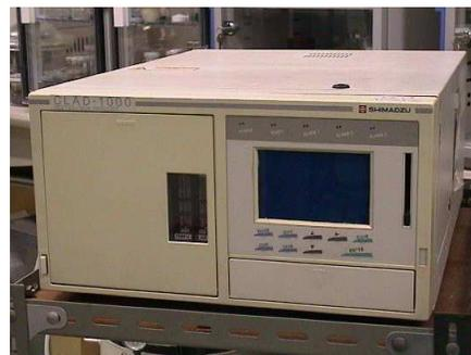
El rango analítico está determinado por el modelo instrumental. En este método, una porción del rango analítico es seleccionada al elegir la escala del sistema de monitoreo. Esta escala debe ser seleccionada de forma tal que la concentración del gas contaminante equivalente al estándar de emisión no sea menor que el 30 % de ésta. Si en algún momento de la medición de la concentración del gas se excede la escala, esta medición se considera inválida.
