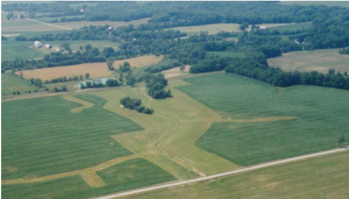
Figura 119. Vista aérea de la aplicación de vías de pasto para el agua en un campo de Ohio, EEUU. Fuente: Natural Resources Conservation Service. Fuente: <http://www.nrcs.usda.gov/>
