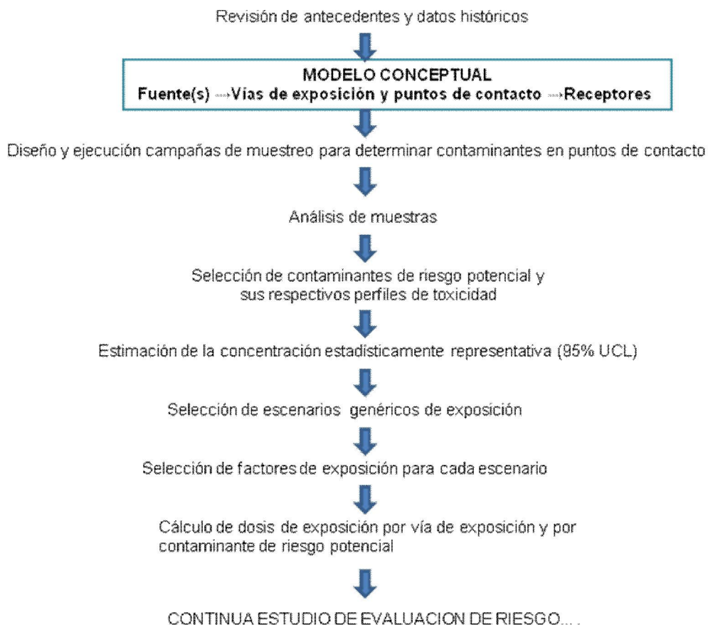
Figura 4.1.- Representación esquemática de los pasos para estimar exposición a contaminantes ambientales seguidos en este estudio. (Fuente: Elaboración propia).
