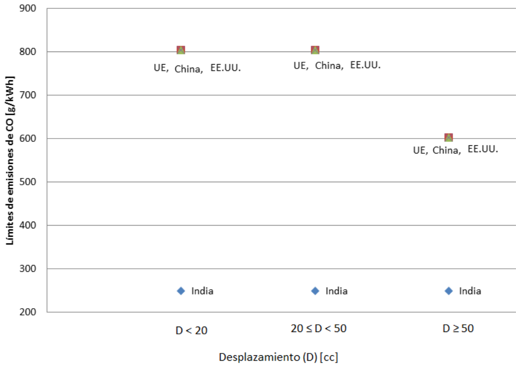
Figura 24: Comparación de los límites para CO en mediciones en laboratorio, motores de chispa equipos portátiles
