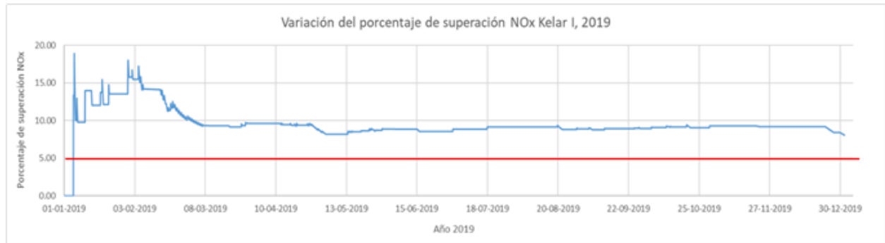
Gráfico 7 Variación del porcentaje de superación de NOx en unidad TG1, año 2019, sin Gas inflexible
