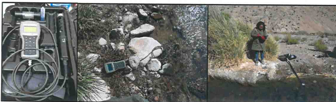
FIGURA 3: MULTIPARÁMETRO PORTÁTIL HANNA HI9828 CON SU SONDA, Y SU UTILIZACIÓN EN LA CAMPAÑA DE MONITOREO EN LA CUENCA DEL HUASCO DESDE EL 16 AL 18 DE AGOSTO DEL AÑO 2019.
