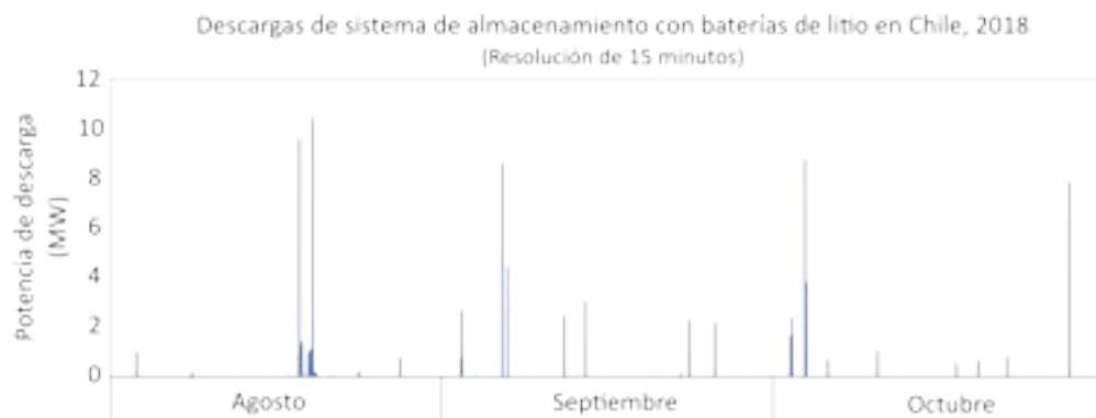
Figura 48 : Descargas de uno de los sistemas de baterías instalados en el SEN-Norte durante algunos meses de 2018. Fuente: Elaboración propia en base a datos del CEN.
