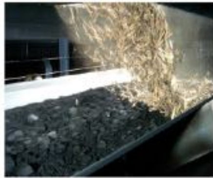
Figura 41: Mezclado de chips de biomasa con carbón en Wallerawang, Australia. Fuente: [20].
