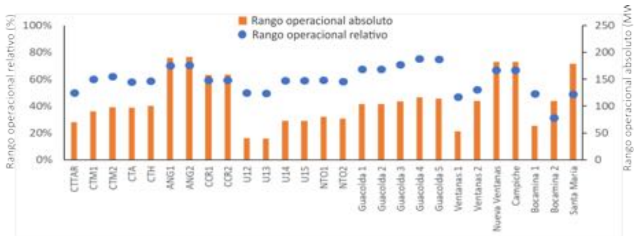
Figura 30: Rango operacional absoluto y relativo de unidades de carbón. Fuente: Elaboración propia.
