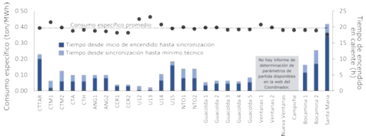
Figura 29: Consumo específico y tiempo de encendido. Fuente: Elaboración propia en base a datos del Coordinador Eléctrico Nacional para la programación de la operación en agosto 2018.
