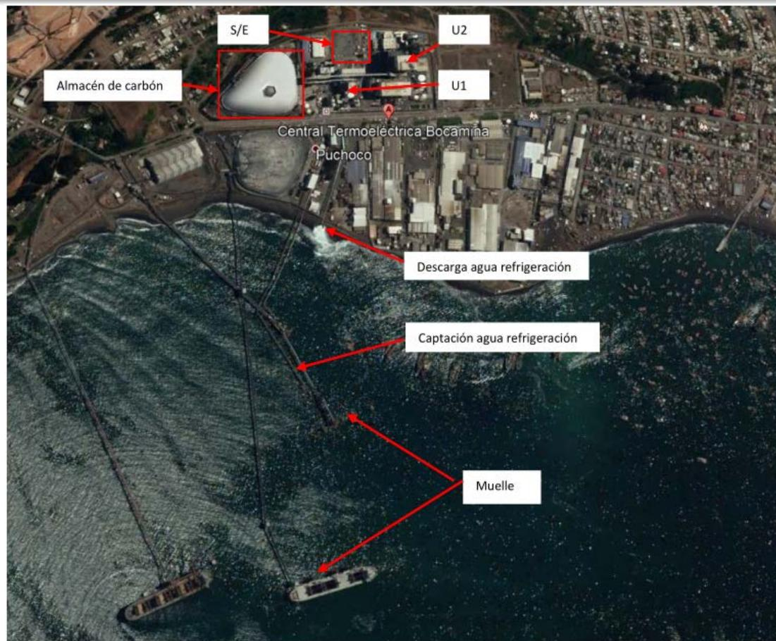
Figura 19: Complejo termoeléctrico Bocamina.
