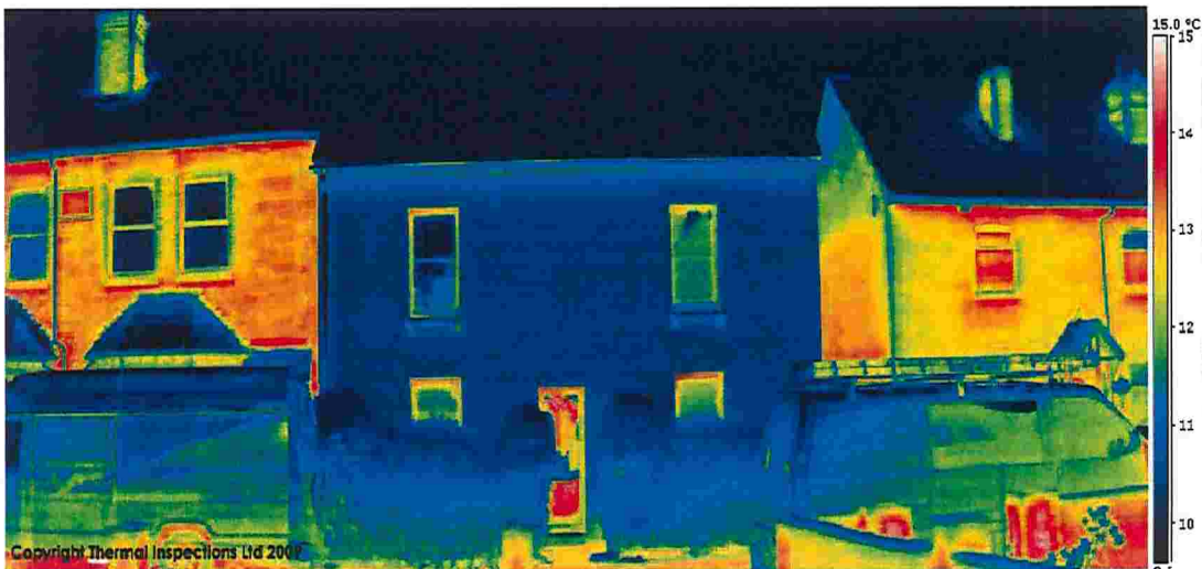
Termografía de una passivhaus (centro) y viviendas tradicionales alemanas
