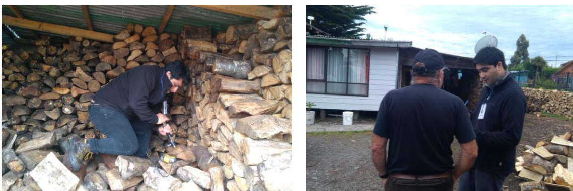
Figura 49. Medición de humedad de leña en viviendas de las comunas de Puerto Montt y Puerto Varas.
