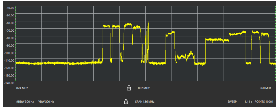
Fig 4.2. Espectro electromagnético en la banda de frecuencia de 824 a 960 MHz.
