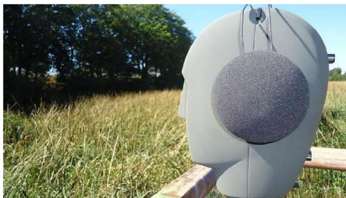
Fig. 124. Dummy Head Neumann, KU 100.
