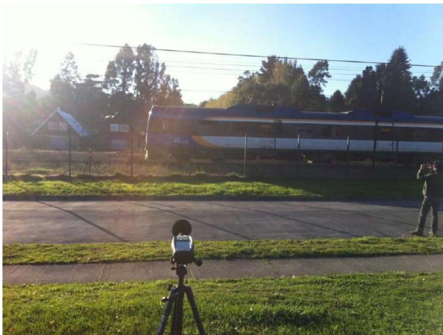
**Fig. 89.** Ejemplo de posición para la medición de niveles de ruido en torno a una línea de ferrocarril, mediante modelo Schall 03.
