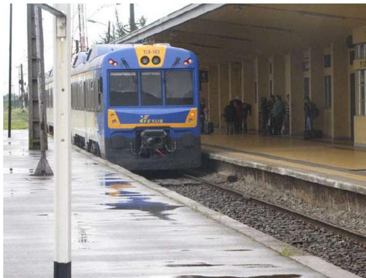
Fig. 88. Automotor Diésel de 2 cuerpos.
