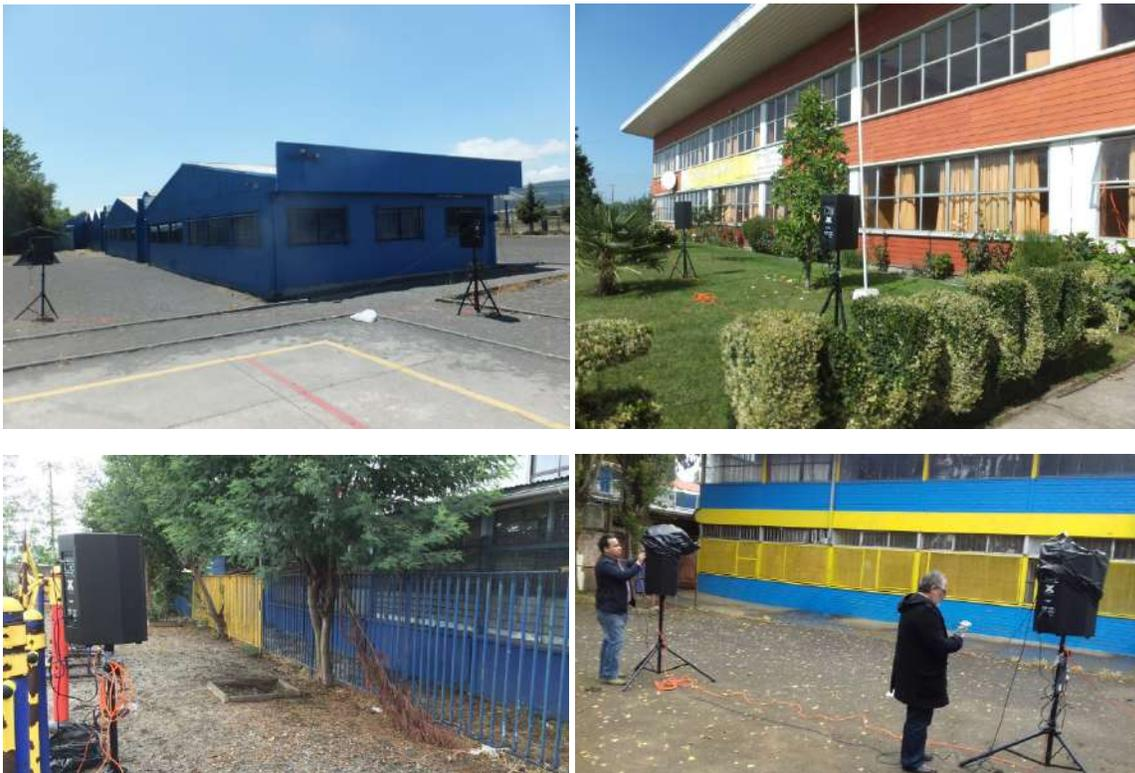
**Figura 20:** Configuración de parlantes durante el test de aislamiento de fachada con fuente de sonido artificial. Fuente: Elaboración propia.
