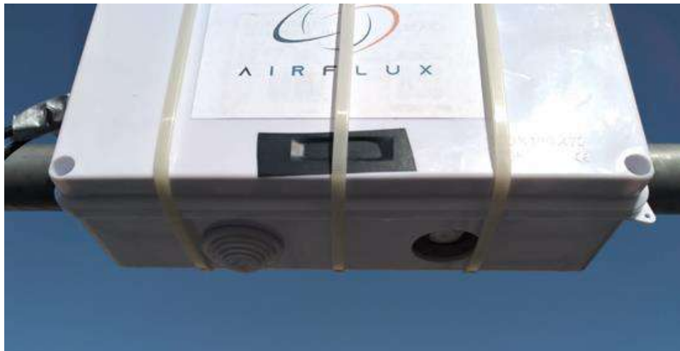
Figura 1.20: Nodo sensor suspendido, donde se observa en el agujero inferior el sensor de COVs.
