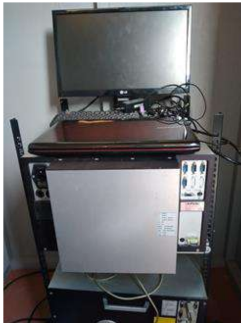
Figura 1.10: Rack con computadores y componentes electrónicos en el interior de la caseta.
