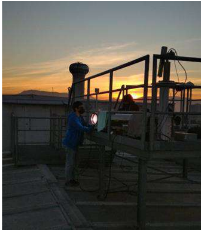
Figura 1.12: Calibración al atardecer, emisor apuntando al edificio de investigación.
