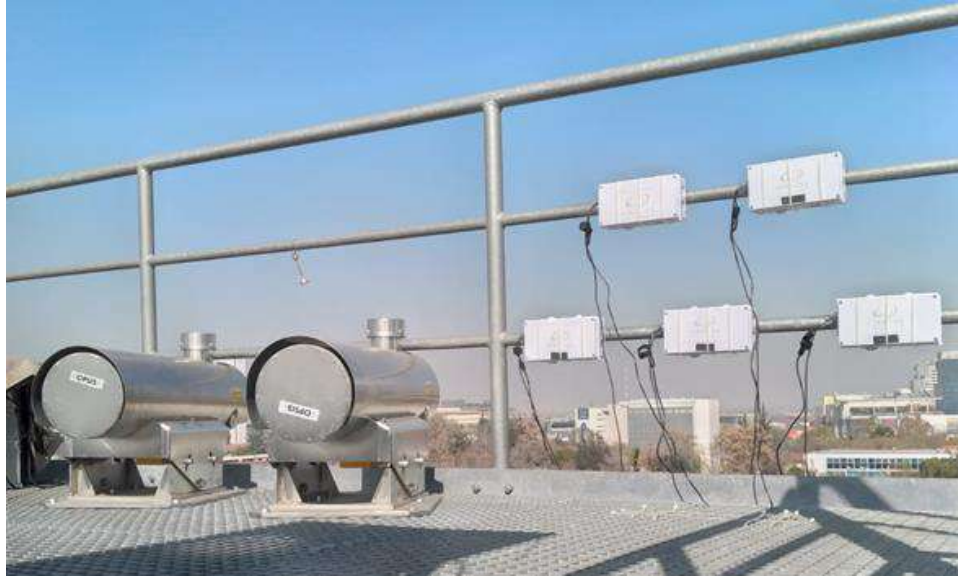
Figura 1.21: Posición final de los nodos, contiguos a los emisores del sistema DOAS.
