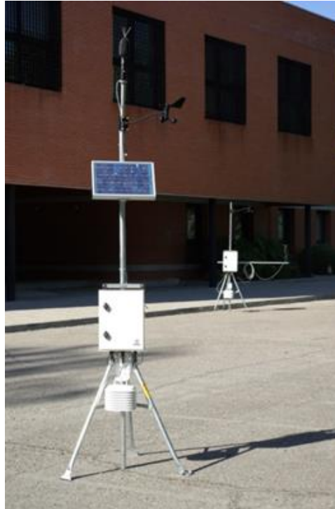
Figura 3.3.24. Ejemplo de estación de monitoreo de ruido ambiental, alimentado por panel solar.
