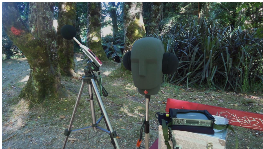
Figura 3.9.16. Sistema de grabación sonora utilizado para el registro de los paisajes sonoros.
