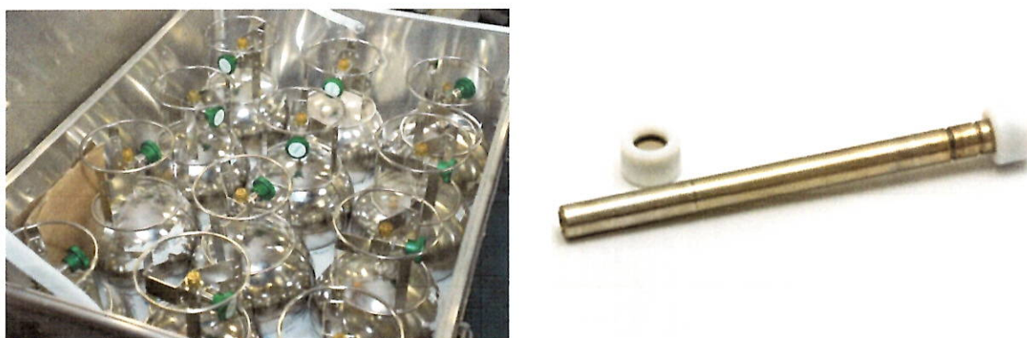
Figura 3: Muestreadores utilizados en las campañas de medición. Cánisters (izquierda) y tubo de adsorción Tenax TA (derecha).
