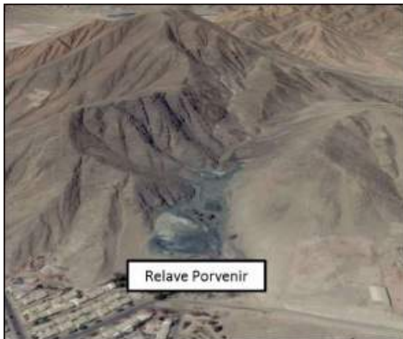
Figura 3-41: Relave Porvenir en valle encajonado. La dirección principal de los vientos modelados coincide con la dirección transversal de este valle, concentrando los vientos en dirección hacia la población El Palomar. Fuente: Elaboración propia
