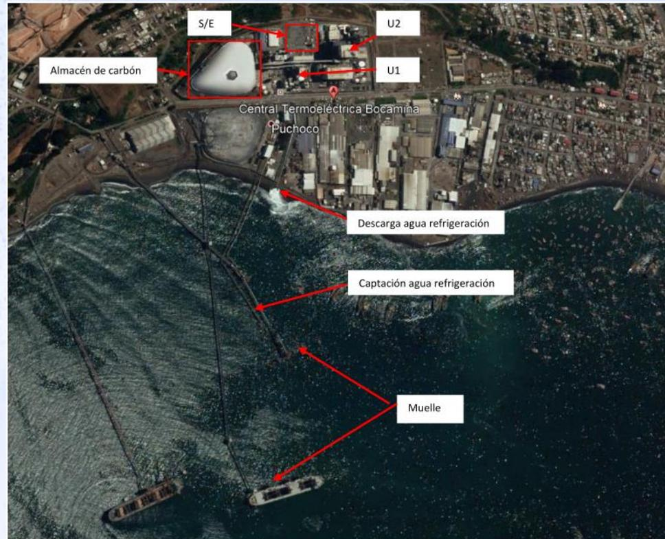
Figura 19: Complejo termoeléctrico Bocamina.
