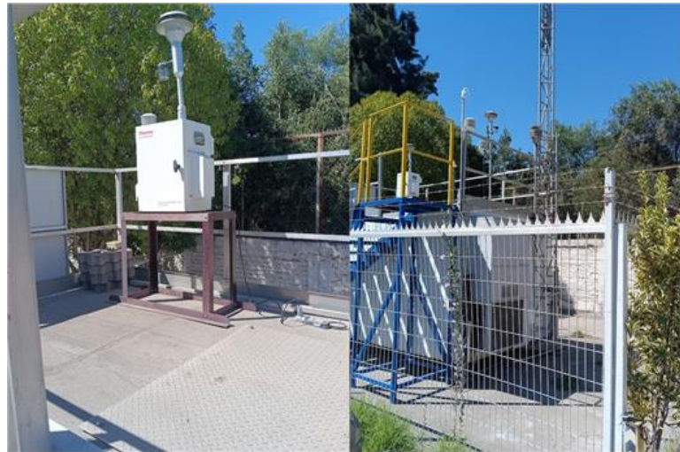
Muestreador Partisol 2000i en estación Pudahuel, Santiago
