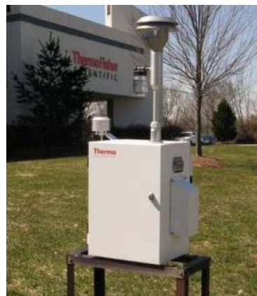
Muestreador bajo volumen Thermo Fisher Scientific Partisol 2000i-D
