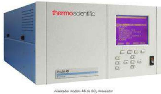
**Figura 4-6 Muestreador de SO<sub>2</sub> Thermo 43i**
