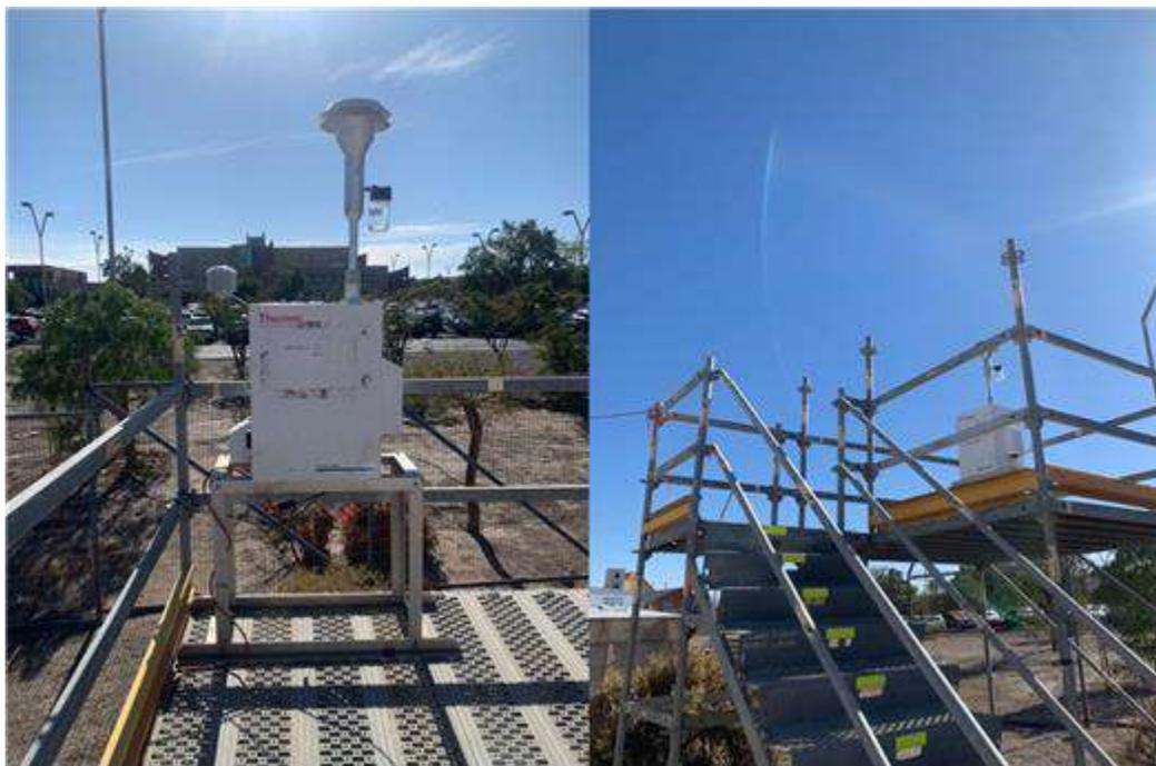
**Figura 7-5 Muestreador MP<sub>10</sub> en estación Hospital El Cobre, Calama.**
