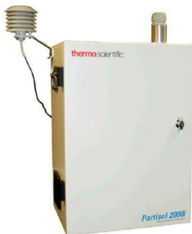
**Figura 4-8 Muestreador de MP<sub>10</sub> Thermo Fisher Scientific Partisol 2000i**
