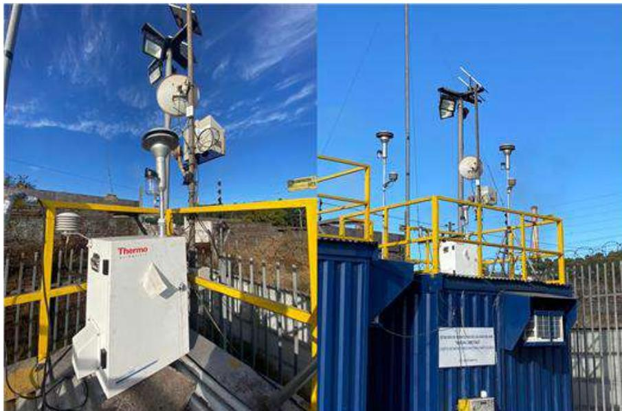
**Figura 7-8 Muestreador MP<sub>10</sub> en estación Nueva Libertad, Talcahuano**
