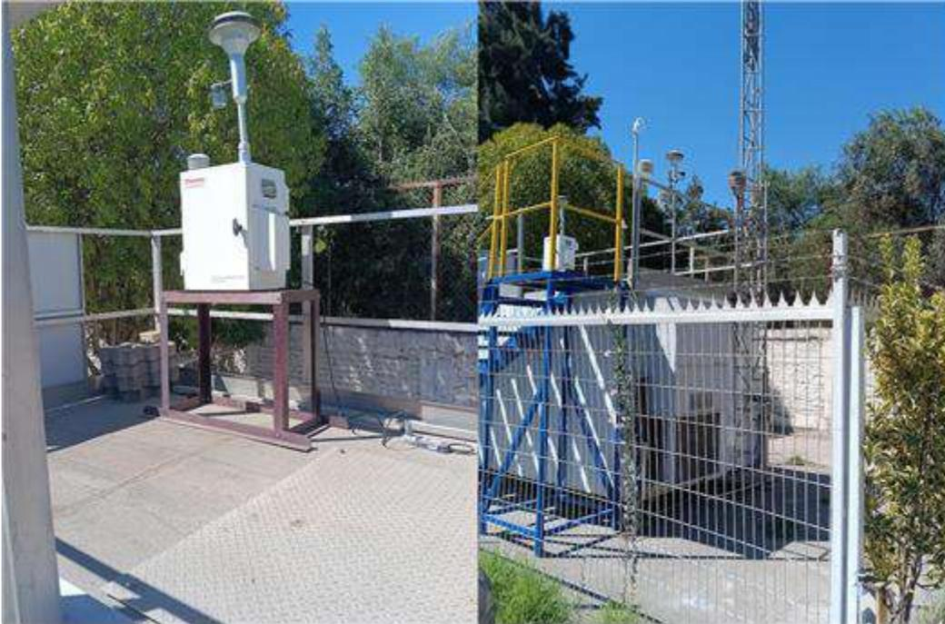
**Figura 7-6 Muestreador MP<sub>10</sub> en estación Pudahuel, Santiago.**
