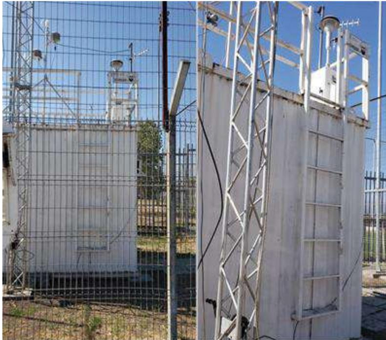
**Figura 7-7 Muestreador MP<sub>10</sub> en estación Rancagua I, Rancagua.**
