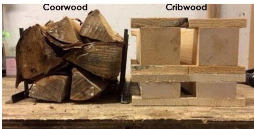
Figura 32. Tipos de configuración de la leña para la realización de pruebas, indicados por EPA
