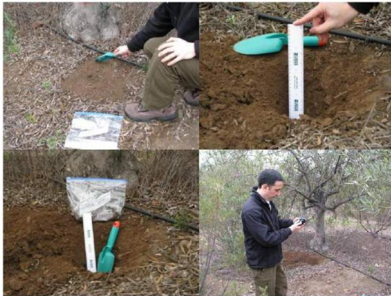
Figura 143. Muestreo de suelo en el Valle de Río Huasco. En cada punto de muestreo se realizó una descripción del lugar y su entorno, condición general del huerto y descripción preliminar del suelo.
