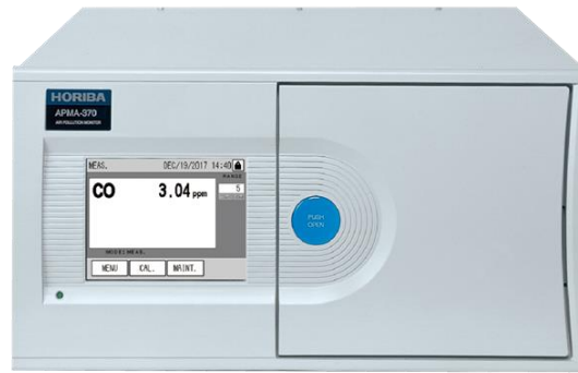
Figura 4-3 Analizador de CO ambiental Horiba APMA-370
