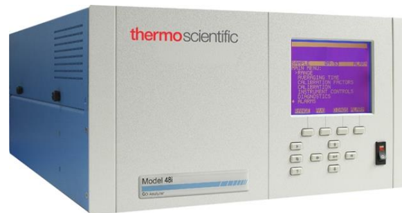
Figura 4-4 Analizador de CO ambiental Thermo Scientific 48i
