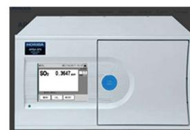
Figura 4-5 Muestreador Horiba APSA 370
