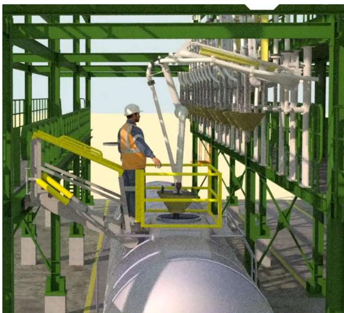
*Ilustración 1. Imagen referencial de mesa de carga con camión.*
