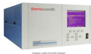
Figura 4-6 Muestreador de SO<sub>2</sub> Thermo 43i
