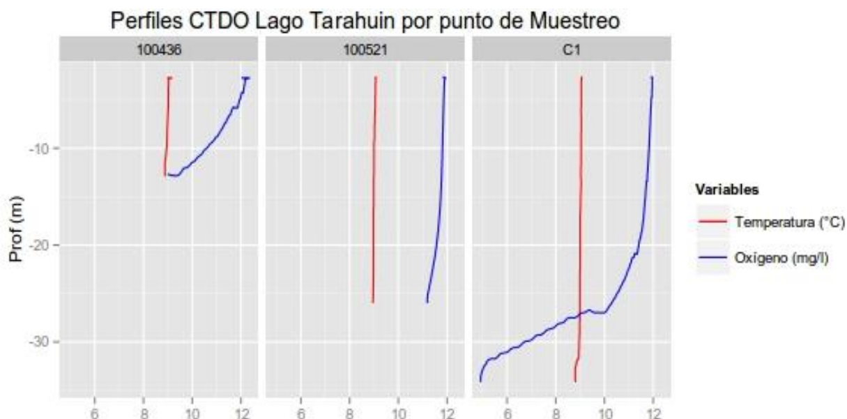
Figura 50. Perfiles fisico-qu3micos (ox3geno en mg/L y temperatura en °C) de la columna de agua de los centros analizados en el lago Tarahu3n.
