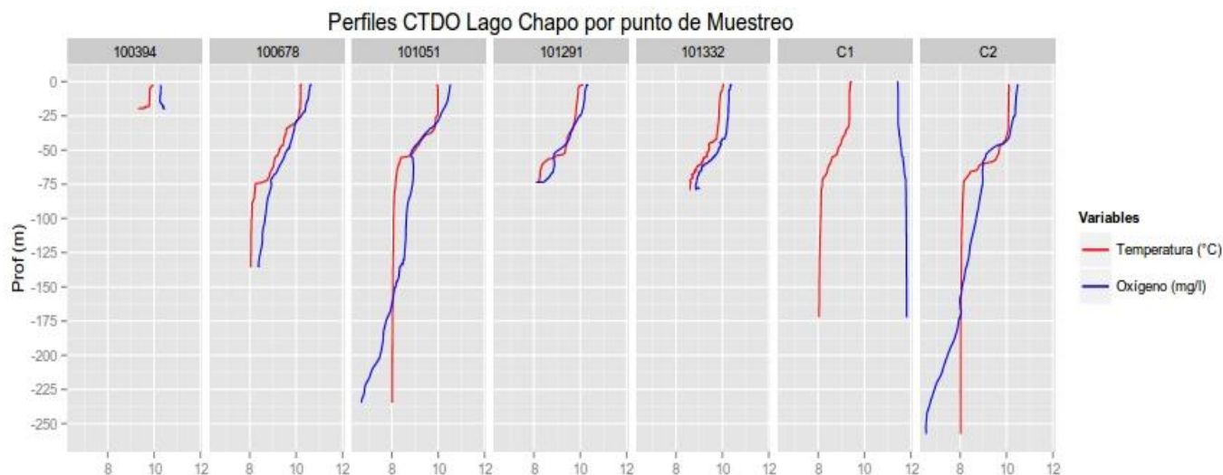
Figura 23. Perfiles físico-químicos (oxígeno en mg/L, y temperatura en °C) de la columna de agua de los centros analizados en el lago Chapo.
