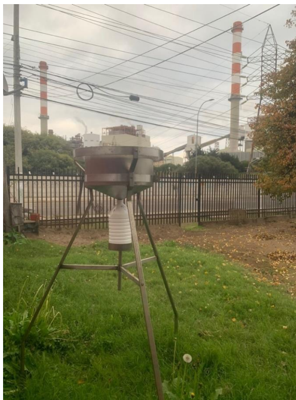
Figura 2 Modelo de Colector pasivo instalado en 4 Estaciones del CTV.
