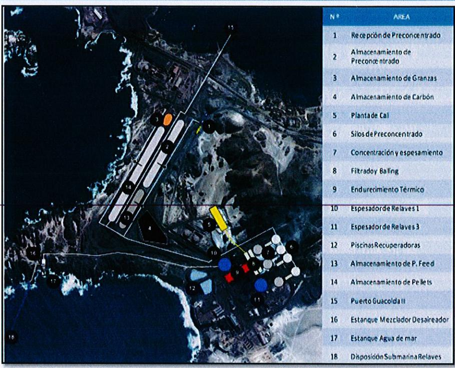
**Figura 1 Áreas de Procesos de Planta de Pellets**
