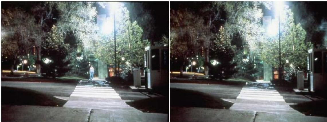
**Figura 15.** En la imagen de la derecha se observa una persona bajo una luminaria del tipo globo con emisiones de luz blanca. Para la imagen de la izquierda no se aprecia con claridad la persona a pesar que se desplazó solo 1 metro hacia la derecha, lo cual evidencia que la seguridad pública está asociada a la forma adecuada de iluminación
